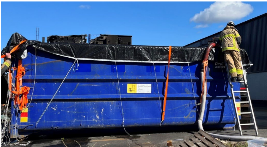
Bild 6 visar batteriet nedsänkt i vattenbad. Källa RSG
